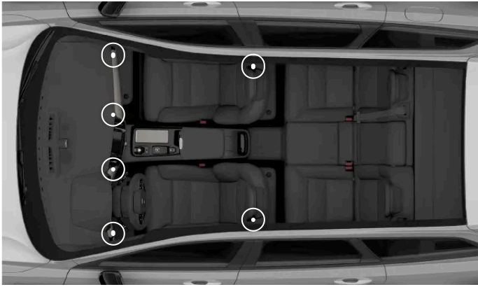
Säädettävien tuuletussuulakkeiden sijainnit
