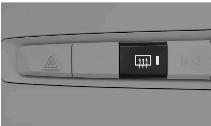
Takahuurteenpoistopainike keskinäytön alapuolella olevassa painikepaneelissa.
