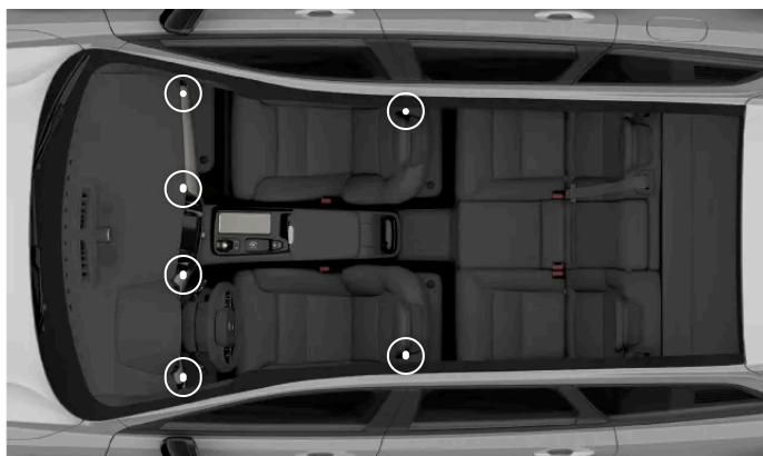
Säädettävien tuuletussuulakkeiden sijainnit
