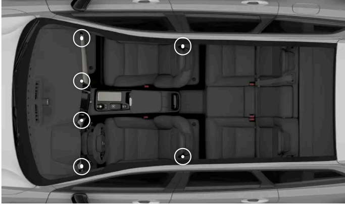
Säädettävien tuuletussuulakkeiden sijainnit
