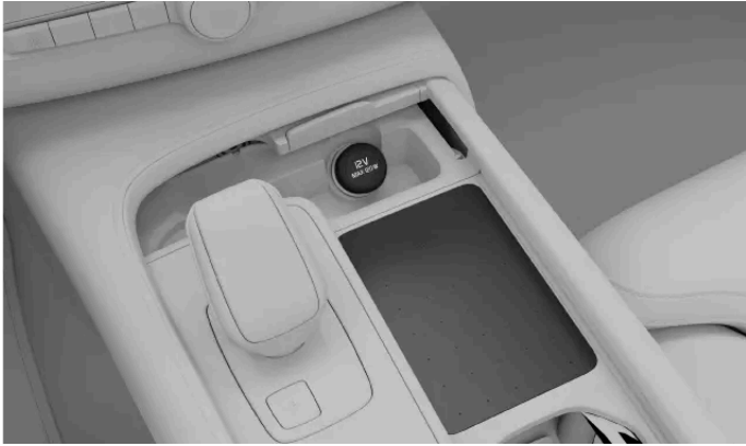
12 V:n pistorasia tunnelikonsolissa
