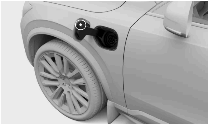
Tunnistetarra sijaitsee latauskannen sisäpuolella.
