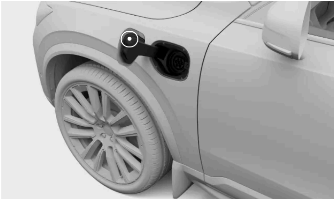
Tunnistetarra sijaitsee latauskannen sisäpuolella.
