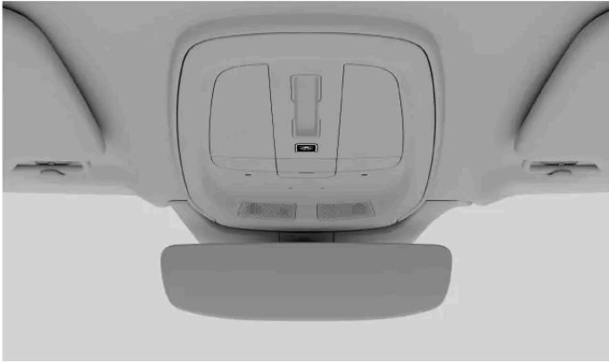
Automaattisen valojen sammutuksen painike kattokonsolissa
