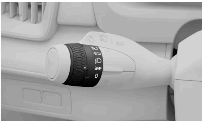
Seisontavalojen symboli vasemmanpuoleisen vivun kiertorengaassa.
