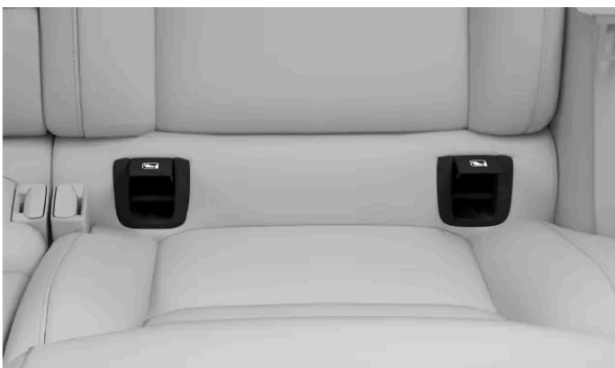
Ulompien takaistuimen ISOFIX-kiinnityspisteiden sijainnit
