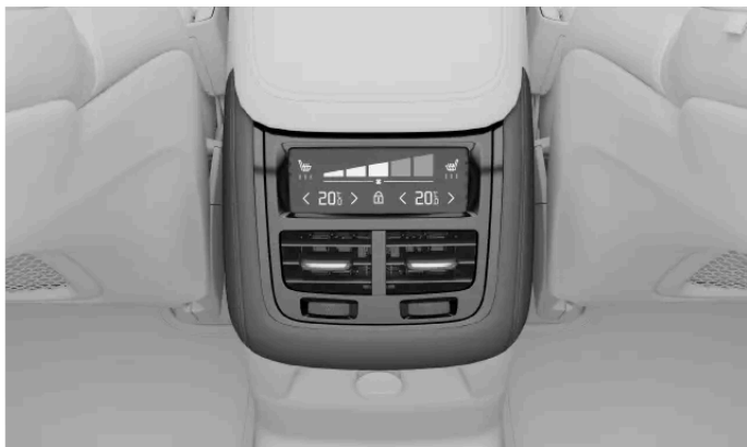
Tunnelikonsolissa olevat ilmastoinnin säätimet
