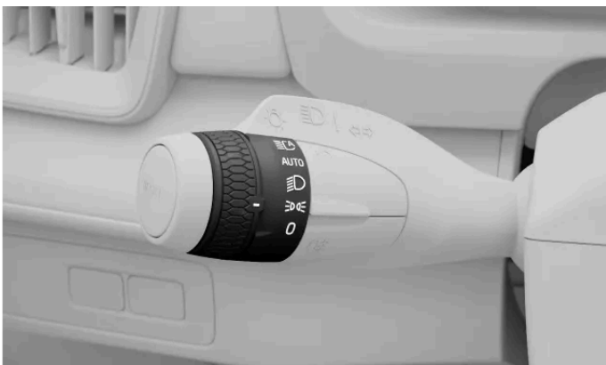
Seisontavalojen symboli vasemmanpuoleisen vivun kiertorengaassa.
