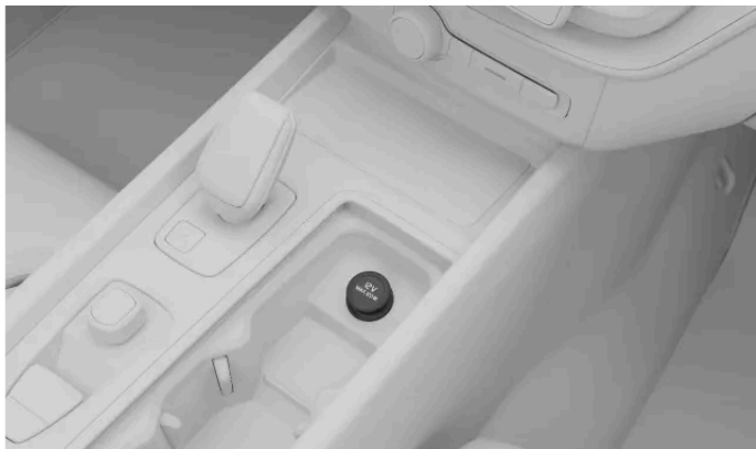
12 V:n pistorasia tunnelikonsolissa
