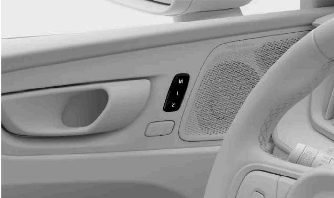
Istuimen esiasetuspainikkeiden sijainti
