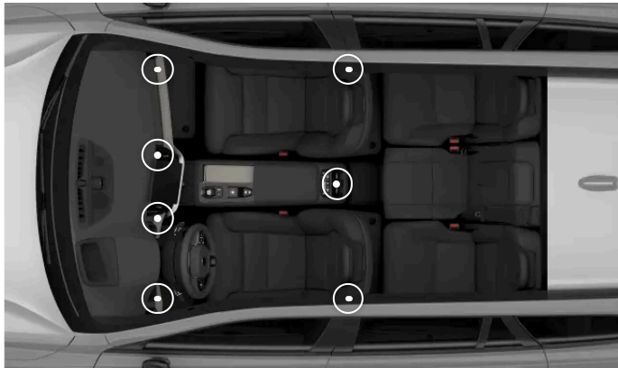
Säädettävien tuuletussuulakkeiden sijainnit
