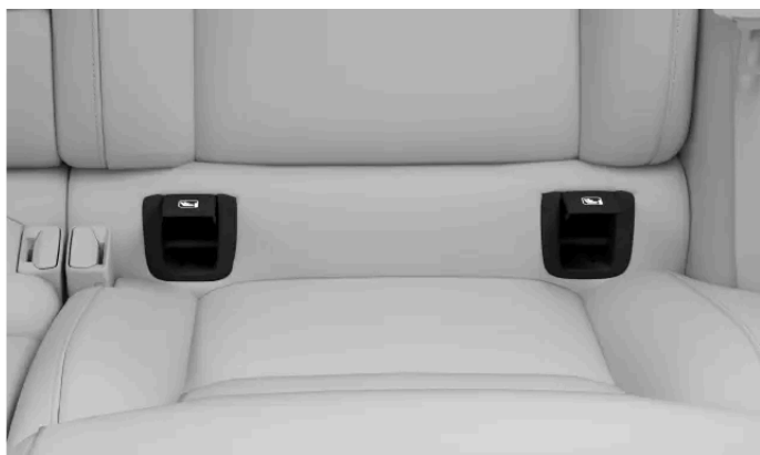
Ulompien takaistuimen ISOFIX-kiinnityspisteiden sijainnit
