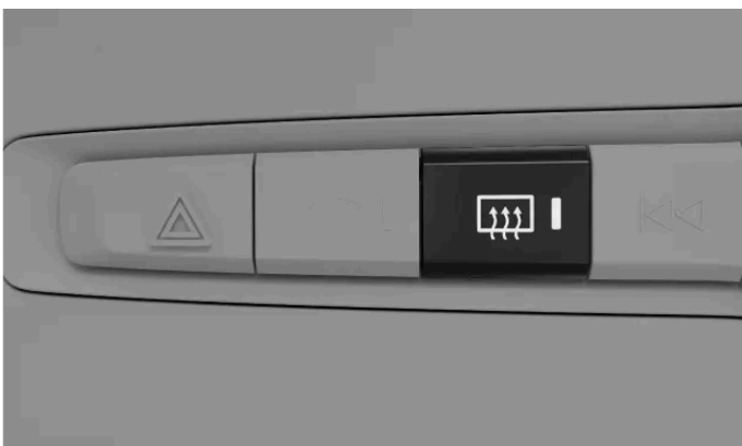
Takahuurteenpoistopainike keskinäytön alapuolella olevassa painikepaneelissa.
