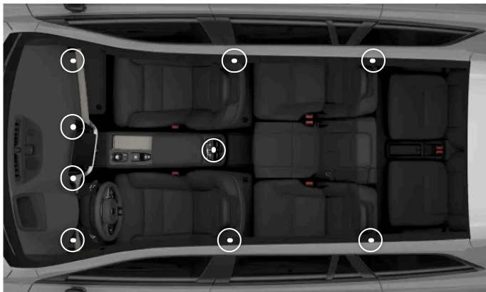
Säädettävien tuuletussuulakkeiden sijainnit
