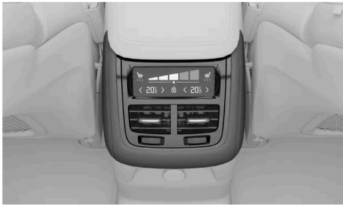
Tunnelikonsolissa olevat ilmastoinnin säätimet
