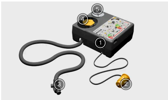
Väliaikaisen renkaanpaikkaussarjan kompressorin yleiskuva
