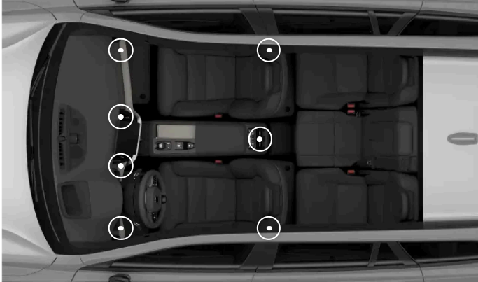
Säädettävien tuuletussuulakkeiden sijainnit
