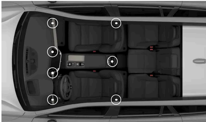
Säädettävien tuuletussuulakkeiden sijainnit
