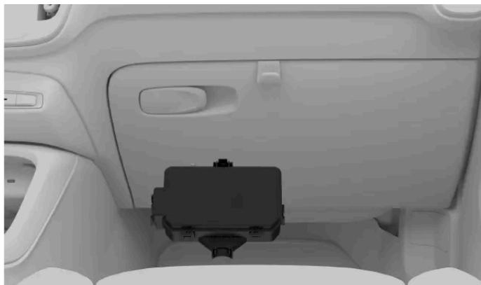
Emplacement de la boîte à fusibles
