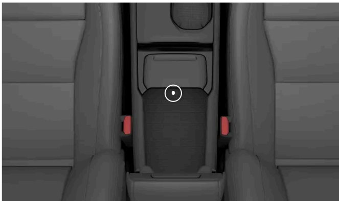
Emplacement du lecteur de secours à l'intérieur du compartiment de rangement de la console de tunnel
