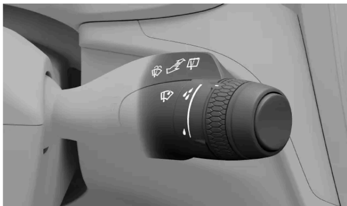
Levier de commande au volant droit
