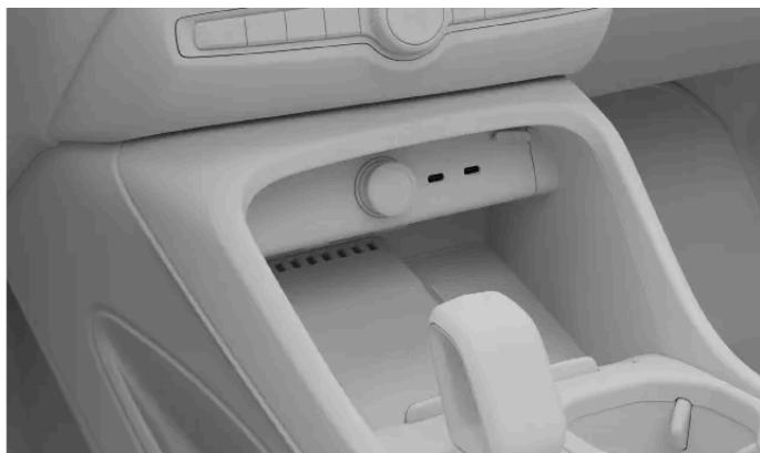
Deux autres ports USB se trouvent à l'arrière de la console de tunnel.
