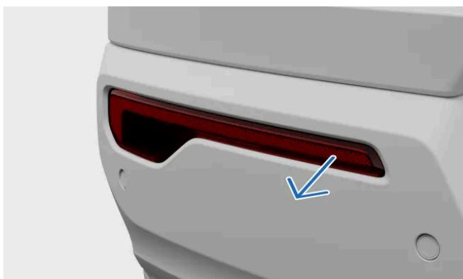
Insérez un tournevis derrière le petit côté le plus étroit du feu antibrouillard et faites levier pour l'extraire.
