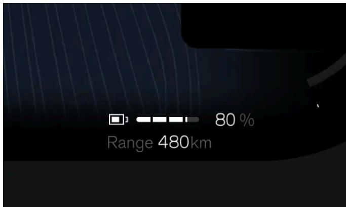
Votre autonomie est principalement liée au niveau de la batterie de votre voiture et à votre conduite, mais des facteurs extérieurs peuvent également intervenir. Le niveau de la batterie et l'autonomie prévue sont affichés à l'écran conducteur. L'autonomie prévue est calculée en fonction de la façon dont vous conduisez actuellement et dont vous avez conduit par le passé.
