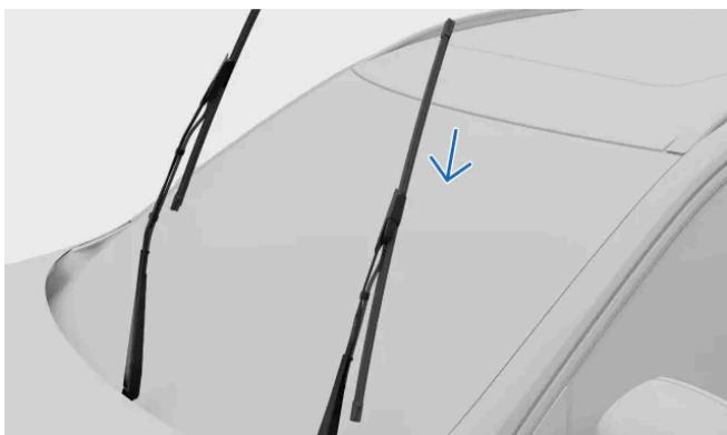
Vérifiez que le balais côté conducteur est plus long que celui du côté passager. Faites glisser le balai d'essuie-glace sur le bras d'essuie-glace. Vérifiez que la goupille du bras d'essuie-glace entre dans l'orifice du balais d'essuie-glace. Poussez le balai dans le bras d'essuie-glace jusqu'à ce qu'un déclic se fasse entendre.
