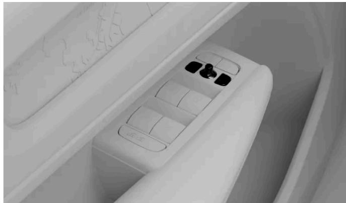
Commandes de réglage des rétroviseurs extérieurs
