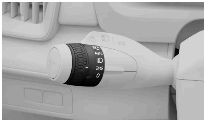
Symbol des feux de position sur la bague tournante du levier de commande gauche
