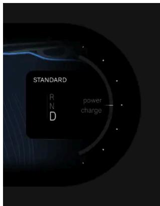
Le mode de conduite sélectionné est indiqué au-dessus du rapport sélectionné dans l'écran conducteur.
