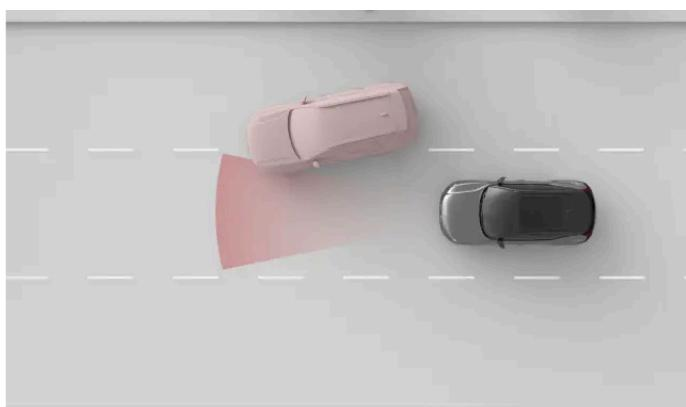
La largeur de la zone de détection du radar avant est limitée. Si un autre véhicule vous fait une queue-de-poisson, la détection peut se produire assez tardivement et entraîner une réponse soudaine de votre voiture.
