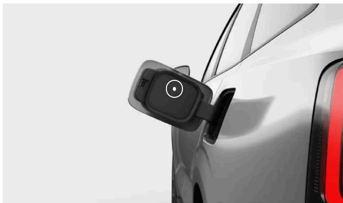
L'étiquette signalétique est placée sur l'intérieur du couvercle de recharge.
