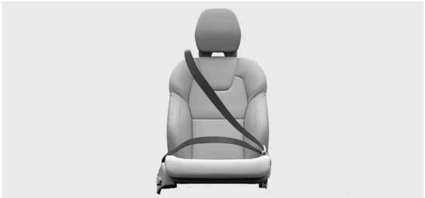
La ceinture de sécurité se verrouille pour faire office de dispositif de retenue dans certaines conditions, par exemple en cas de traction brusque et forte sur la ceinture, si la voiture est conduite de manière agressive ou si elle se trouve dans une forte pente.
