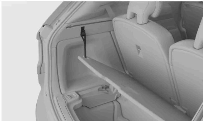
Ouvrez la trappe de soute avec le cordon suspendu au crochet pour sac
