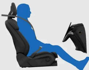
Un occupant correctement assis. Restez dans cette position lorsque la voiture est en mouvement.
