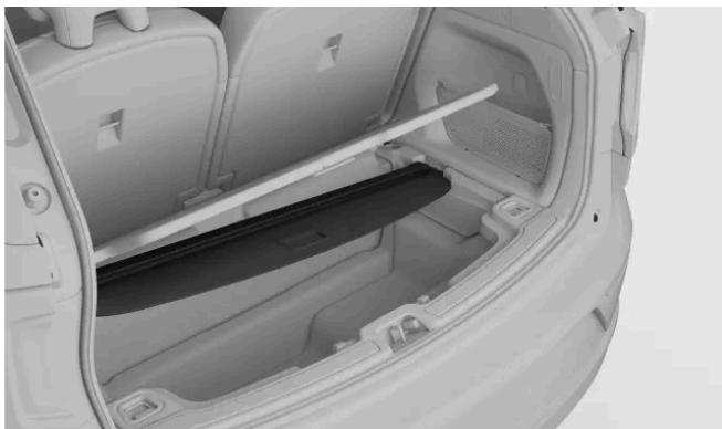
Placez l'extrémité droite du cache-bagages dans le support de cache-bagages, qui se trouve sur le côté droit de la soute.
