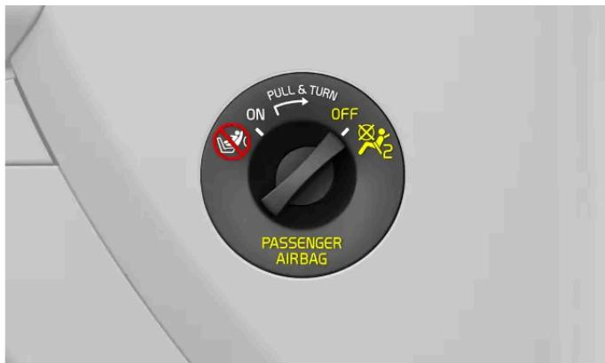
Coussins gonflables désactivés Mettez toujours l'interrupteur dans cette position lorsqu'un siège pour enfant dos à la route est placé sur le siège passager avant.
