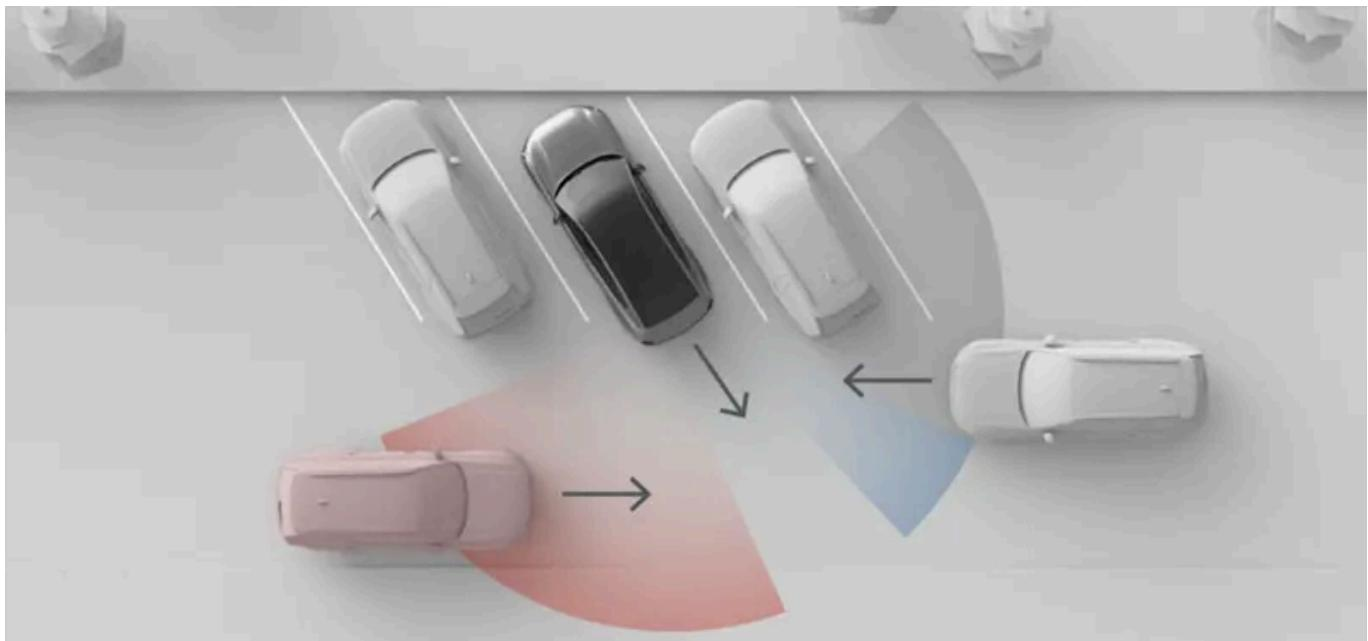
Cette image illustre la façon dont des objets environnants, par exemple des voitures en stationnement, peuvent limiter la capacité de la voiture à détecter d'autres véhicules et des situations à risque. En l'absence d'obstacle, les zones de détection effectives sont identiques des deux côtés.
