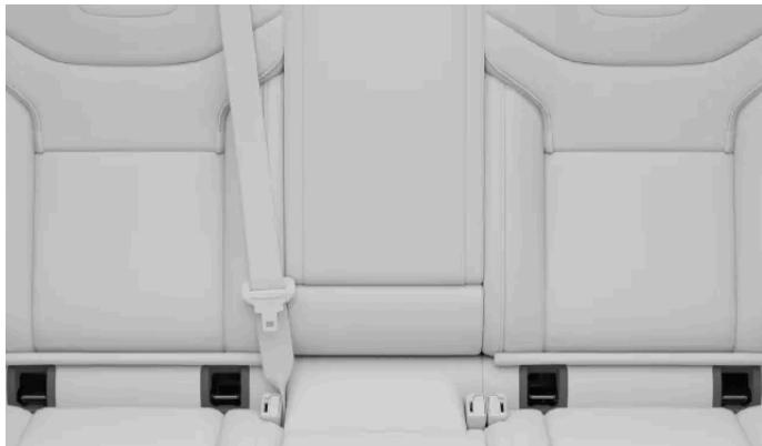
Position des points de fixation ISOFIX pour les sièges arrière
