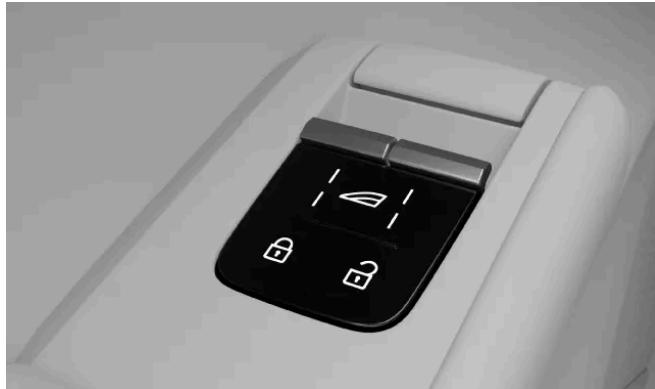
Appuyez sur le symbole de vitre
