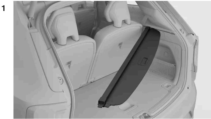
Placez l'une des extrémités du cache-bagages dans le renforcement dans la rainure d'un côté du coffre. Le renforcement est signalé par une ligne. Vérifiez que l'extrémité du cache-bagages est alignée sur la ligne de repère.
