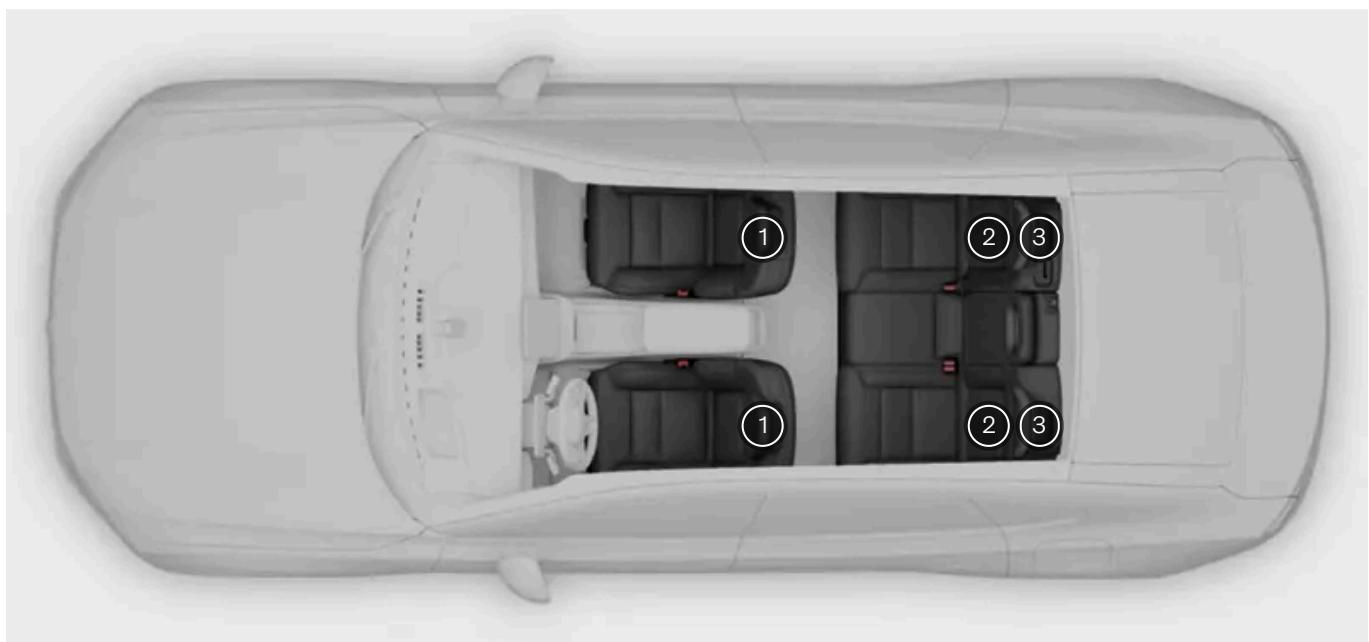
(1) Points de fixation de sangle inférieure sur les rails au plancher des sièges avant<sup>[1]</sup>
