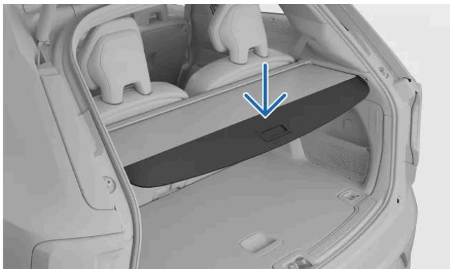
Inclinez le bord extérieur du cache-bagages vers le bas de sorte qu'il se verrouille dans les rainures.
