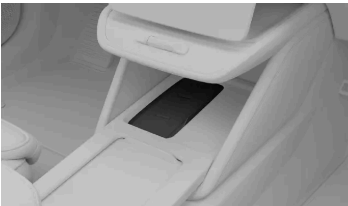
Le lecteur de clé situé entre les sièges avant fait également office de chargeur sans fil.
