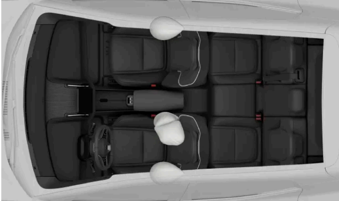
Coussins gonflables latéraux pour les occupants avant
