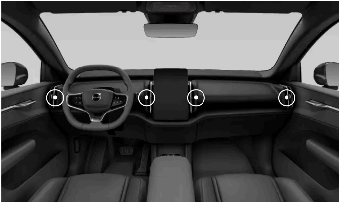
Position des buses de ventilation réglables
