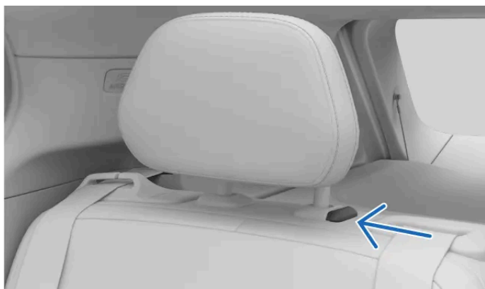
Bouton de verrouillage sur l'appui-tête
