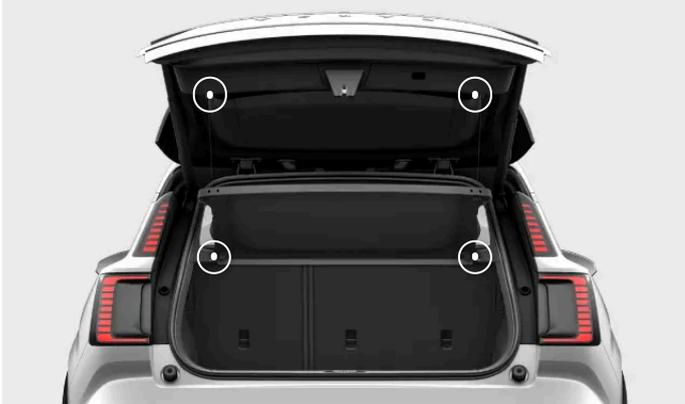
La plage arrière comporte deux points de fixation et le hayon en comporte deux également. Lorsque la plage arrière est fixée, des cordons relient les points de fixation sur la plage arrière et les points de fixation sur le hayon de coffre.
