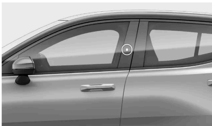
Emplacement du lecteur de clé sur le montant de porte conducteur
