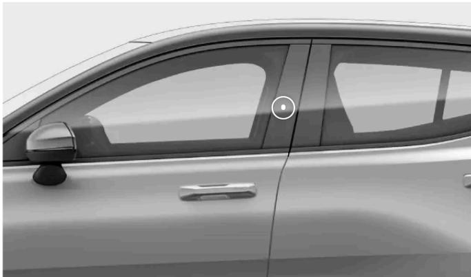
Zone de détection de clé sur le montant de porte conducteur
