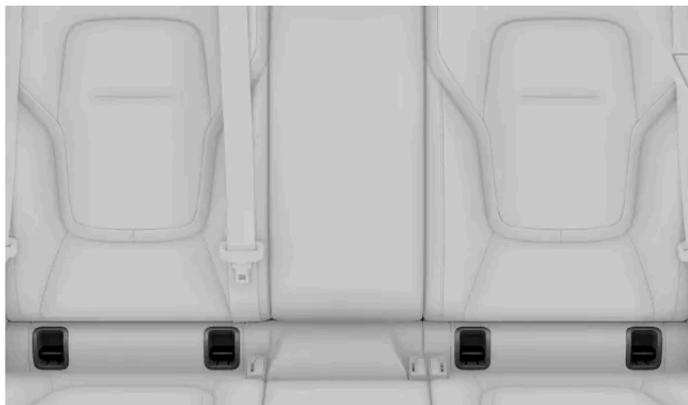
Les points de fixation ISOFIX de siège arrière sont situés dans la partie inférieure du dossier des sièges arrière extérieurs, derrière un cache. Le cache doit être ouvert pour accéder aux points de fixation qui se trouvent derrière.
