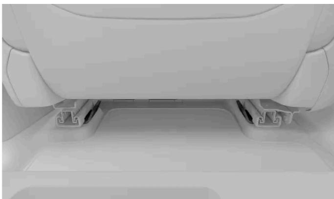
Les points de fixation de sangle inférieure des sièges arrière sont situés à l'arrière des rails du siège avant concerné, au plancher.
