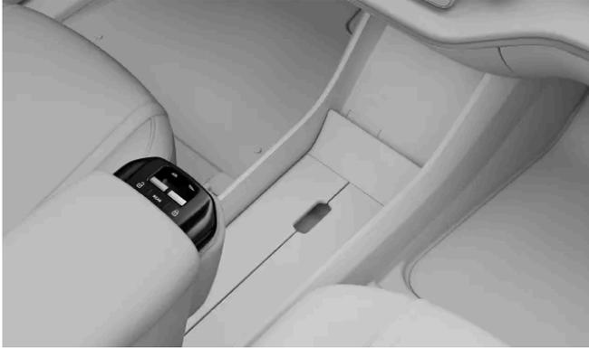
Vous pouvez commander toutes les vitres électriques depuis le siège avant. Appuyez sur le bouton portant la mention REAR pour alterner l'actionnement des vitres avant et arrière. Le bouton prend la couleur ambre pour indiquer que les vitres arrières sont sélectionnées. Les commandes repassent aux vitres avant si vous appuyez à nouveau sur le bouton ou au bout de quelques secondes d'inactivité.
