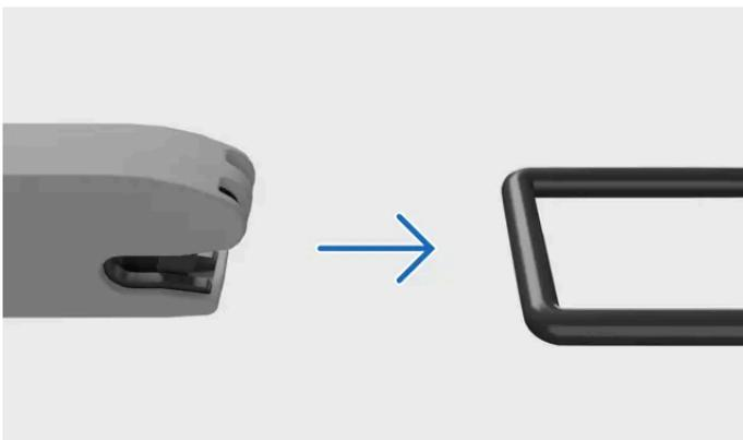
Les sièges enfant installés sur les sièges arrière extérieurs peuvent utiliser ces points de fixation.
