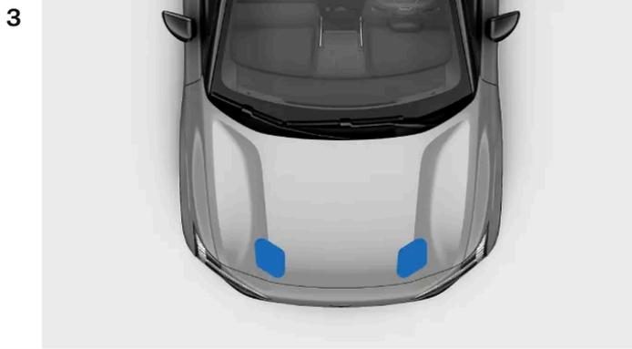
Appuyez sur le bord avant du capot avec les deux mains. Vérifiez que le capot s'enclenche dans les serrures en même temps. Tenez le bord avant à plat pendant la fermeture.
