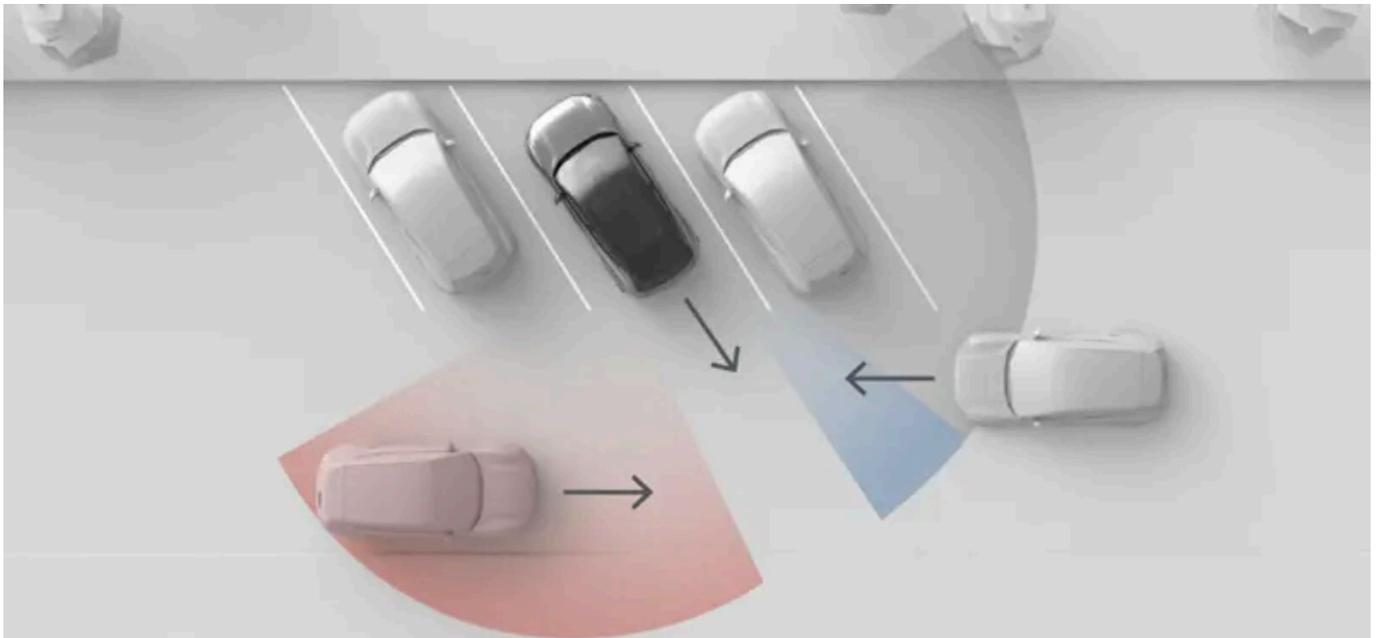
La situation illustrée montre de quelle façon des objets environnants, par exemple des voitures en stationnement, peuvent limiter le champ de détection du radar. En l'absence d'obstacle, les zones de détection effective sont identiques des deux côtés.
