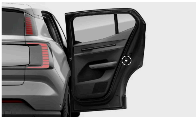
Emplacement des interrupteurs de sécurité enfant.
