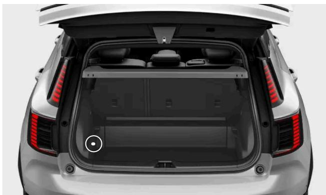
**3** Retirez le cache en faisant levier avec un tournevis ou avec un outil semblable.
