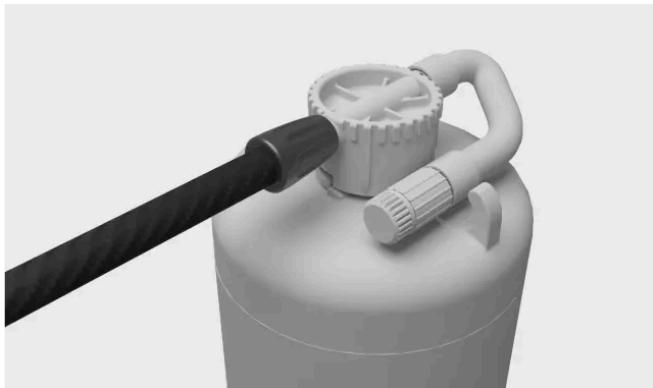
Vissez le flexible pneumatique sur le flacon de liquide d'étanchéité. Un emplacement prévu pour cela se trouve à côté du flexible de liquide d'étanchéité.
