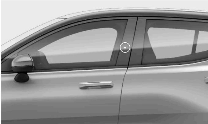
Zone de détection de clé sur le montant de porte
