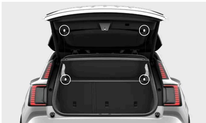
La plage arrière comporte deux points de fixation et le hayon en comporte deux également. Lorsque la plage arrière est fixée, des cordons relient les points de fixation sur la plage arrière et les points de fixation sur le hayon de coffre.
