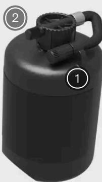
Vue du flacon de liquide d'étanchéité du kit de réparation temporaire de crevaison
