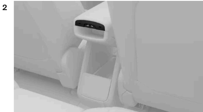
Depuis les sièges arrière, vous pouvez actionner les vitres arrière à l'aide des interrupteurs situés à l'extrémité arrière de l'accoudoir central.
