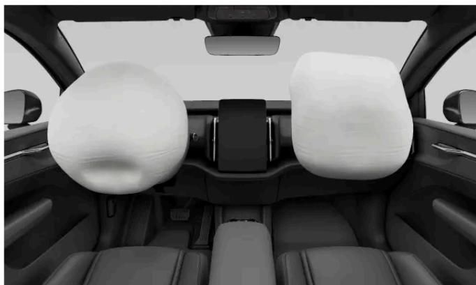
Le coussin gonflable du côté conducteur est placé à l'intérieur du volant.
