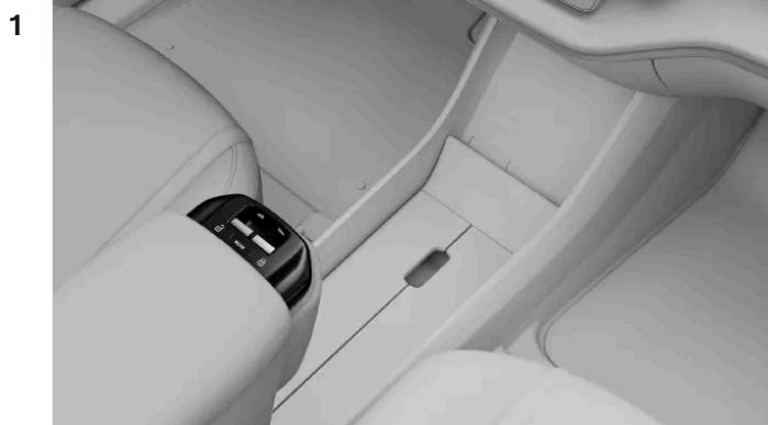
Vous pouvez commander toutes les vitres électriques depuis le siège avant. Appuyez sur le bouton portant la mention REAR pour alterner l'actionnement des vitres avant et arrière. Le bouton prend la couleur ambre pour indiquer que les vitres arrières sont sélectionnées. Les commandes repassent aux vitres avant si vous appuyez à nouveau sur le bouton ou au bout de quelques secondes d'inactivité.
