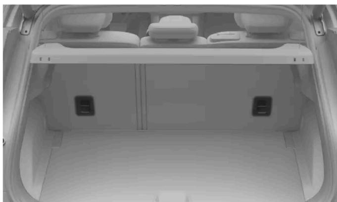
Les points de fixation de sangle supérieure pour les sièges arrière sont situés à l'arrière des sièges arrière extérieurs.
