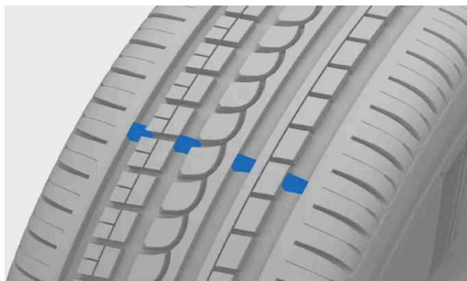
Les talons étroits placés en travers des sculptures du pneumatique sont des témoins d'usure. Sur le côté du pneumatique figure la mention TWI<sup>[1]</sup>.
