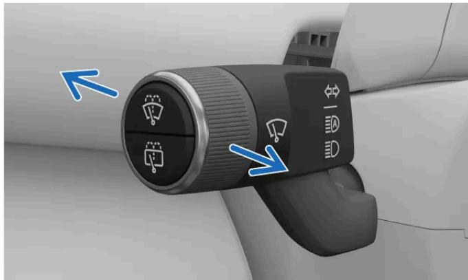
Vous pouvez déplacer le levier de commande au volant gauche vers l'avant ou vers l'arrière pour alterner entre les différentes options de feux de route. Le levier revient toujours à la position neutre.
