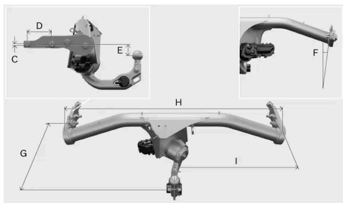
Cotes, points de fixation en millimètres (pouces)
