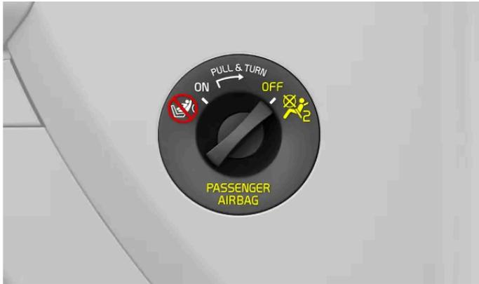
Coussin gonflable désactivé Mettez toujours l'interrupteur dans cette position lorsqu'un siège pour enfant dos à la route est placé sur le siège passager avant.
