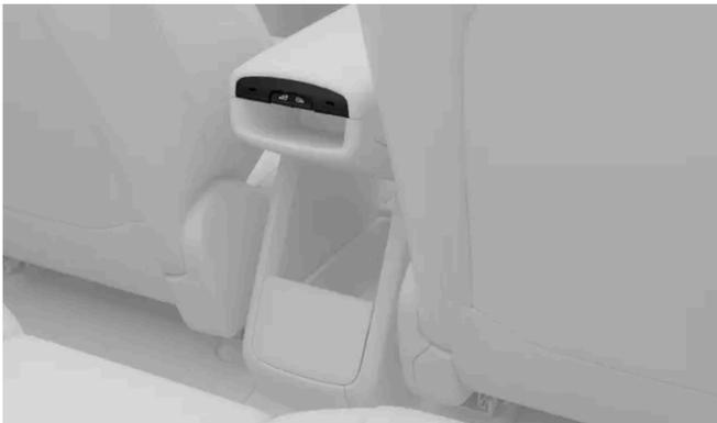
Depuis les sièges arrière, vous pouvez actionner les vitres arrière à l'aide des interrupteurs situés à l'extrémité arrière de l'accoudoir central.
