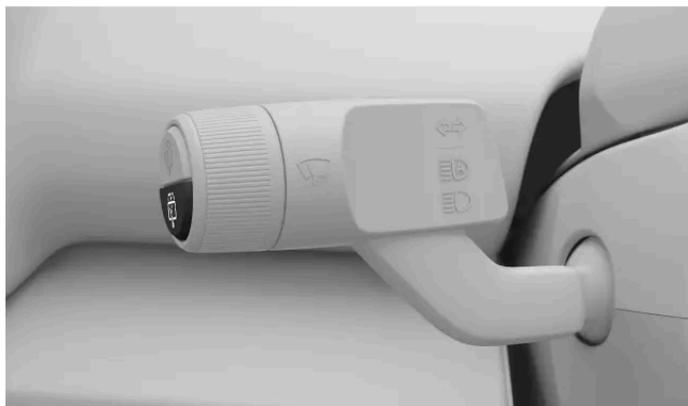
Vous contrôlez l'essuie-glace de lunette arrière en utilisant le bouton inférieur du levier de commande au volant gauche.
