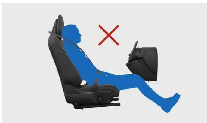
Ne glissez pas vers l'avant sur le siège. Le bas du dos doit être au contact du dossier.
