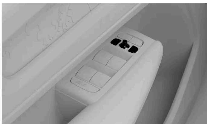
Commandes de réglage des rétroviseurs extérieurs
