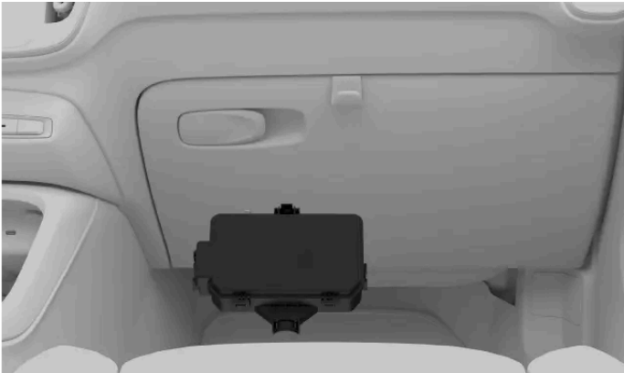
Emplacement de la boîte à fusibles
