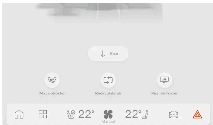
Position du bouton de feux de détresse sur l'écran central
