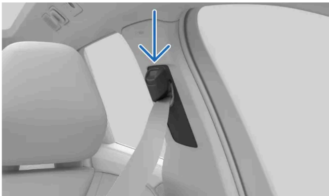
Point de fixation supérieur de ceinture de sécurité
