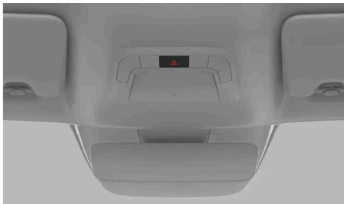
Position du bouton de feux de détresse sur la console au plafond
