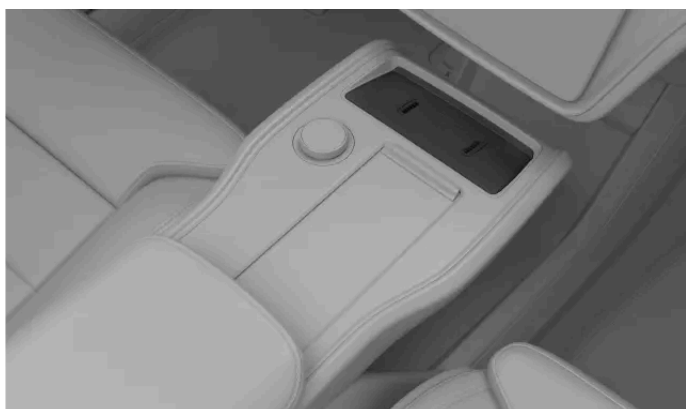
Le lecteur de cartes situé entre les sièges avant fait également office de chargeur sans fil.
