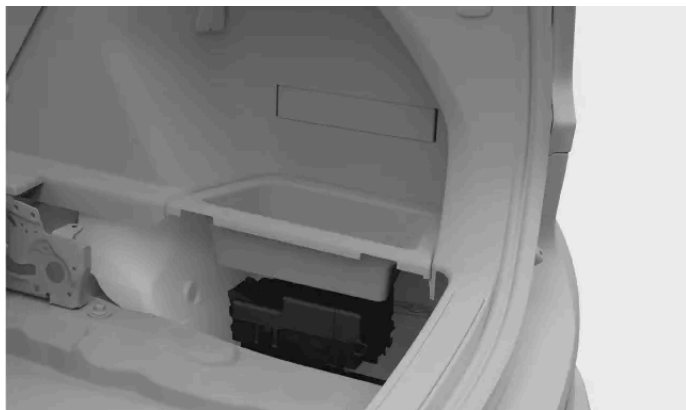
Emplacement de la boîte à fusibles
