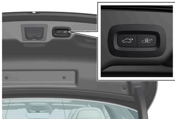
Position du bouton sur le dessous du couvercle de coffre.
