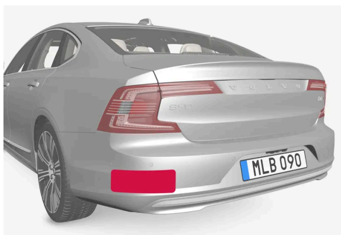
Position des unités radar arrière
