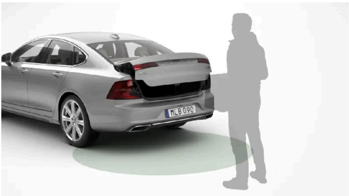
Si la voiture est équipée du verrouillage et déverrouillage sans clé\*, il est possible d'ouvrir le coffre à bagages avec un mouvement du pied. Pour la fermeture, la voiture doit par ailleurs être équipée du coffre à bagages à commande électrique\*.
