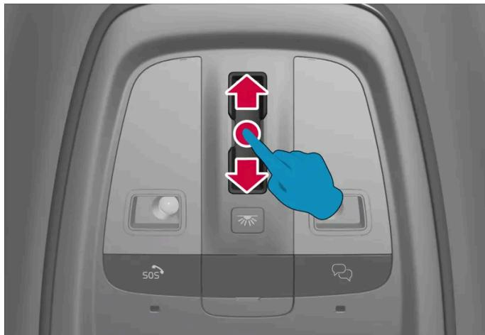
Ouvrez le toit ouvrant en faisant glisser votre doigt vers l'arrière sur la commande. Le toit ouvrant atteint d'abord la position de confort [1]. Pour l'ouvrir en position maximale, faites glisser une seconde fois votre doigt vers l'arrière sur la commande.
