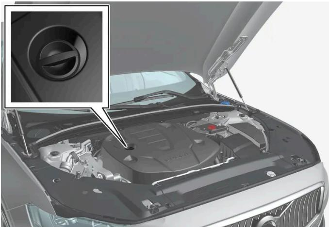
Tuyau de remplissage<sup>[1]</sup>,<sup>[2]</sup>
