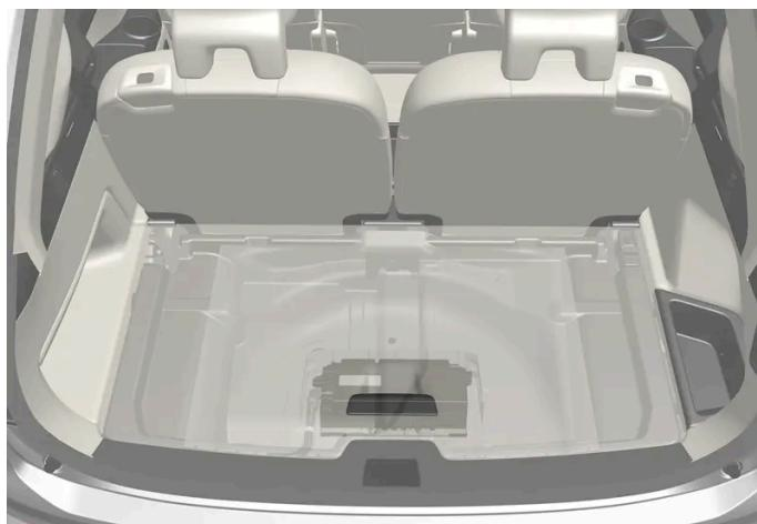
Les véhicules de type microhybride disposent d'une batterie auxiliaire de 48 V placée sous le compartiment à bagages. Les interventions sur la batterie et sur son boîtier doivent être effectuées uniquement par un atelier agréé.
