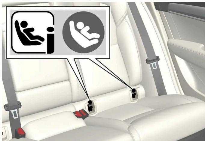
La position des points de fixation pour la banquette arrière est indiquée par des symboles<sup>[1]</sup> sur les caches qui dissimulent les points de fixation.
