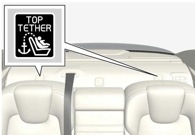
L'emplacement des points de fixation pour la banquette arrière est indiqué par des symboles sur la plage arrière, derrière la banquette arrière.
