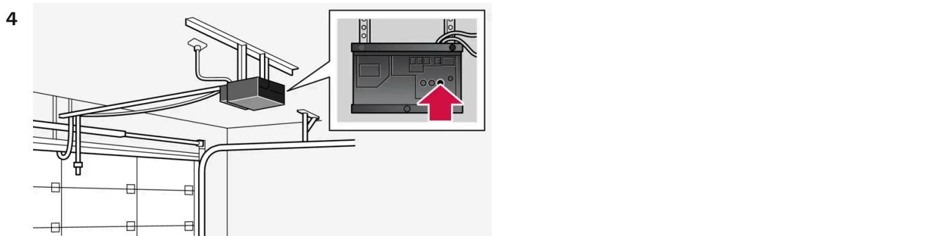
Cherchez le bouton d'apprentissage [2] sur le récepteur de la porte de garage par exemple. Il est généralement placé près de la fixation de l'antenne sur le récepteur.
