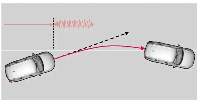
L'assistance de sortie de voie avertit le conducteur par des vibrations dans le volant.
