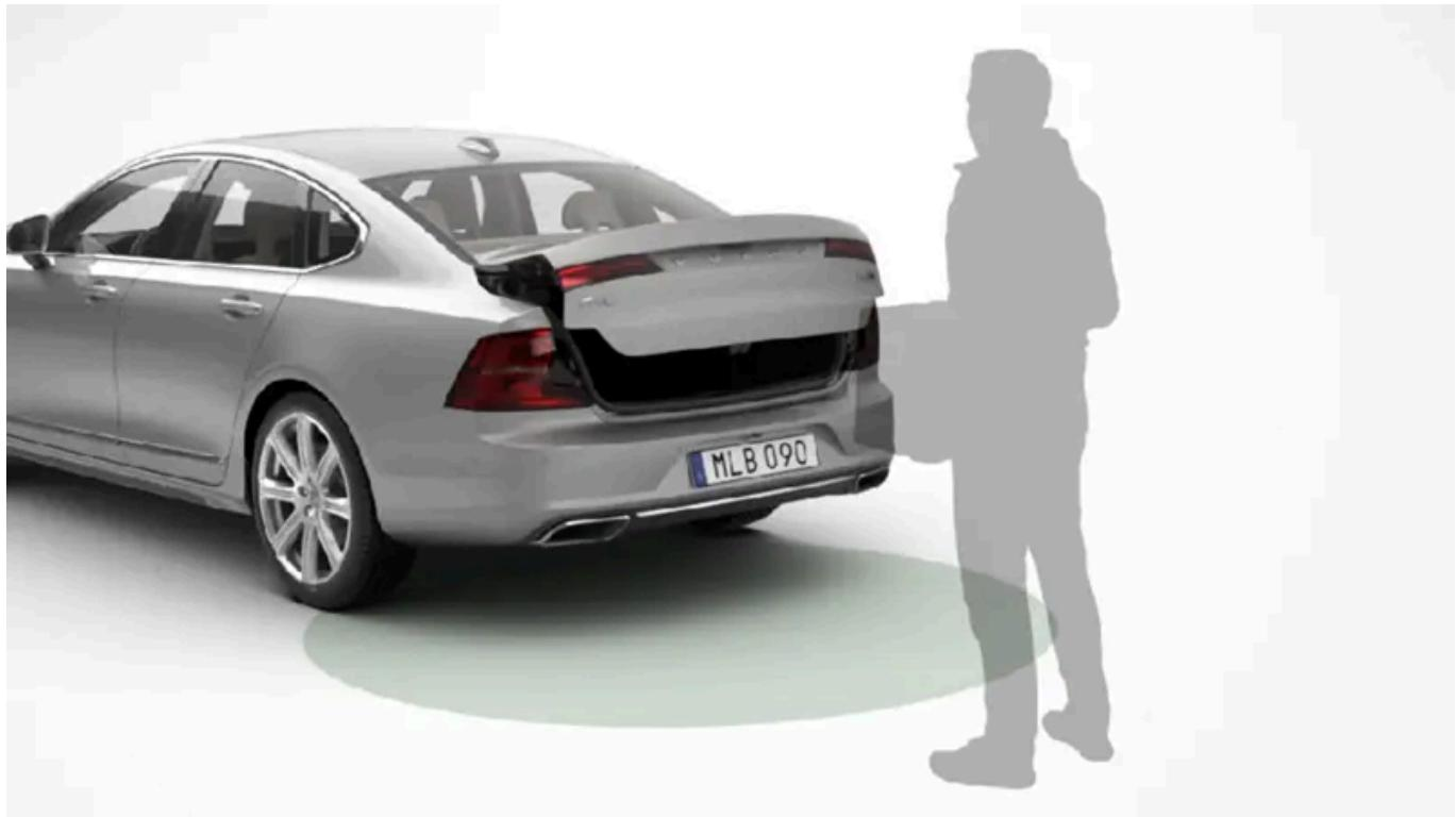
Si la voiture est équipée du verrouillage et déverrouillage sans clé\*, il est possible d'ouvrir le coffre à bagages avec un mouvement du pied. Pour la fermeture, la voiture doit par ailleurs être équipée du coffre à bagages à commande électrique\*.
