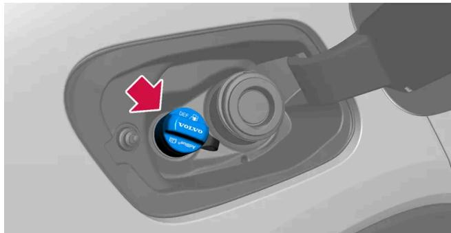
Ouvrez le couvercle bleu du petite tuyau de remplissage destiné à l'AdBlue.
