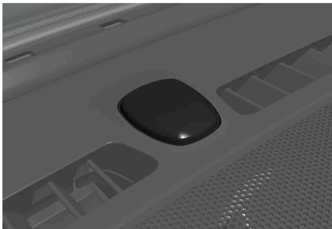
Le témoin de verrouillage et d'alarme est placé au centre du tableau de bord, près du pare-brise.
