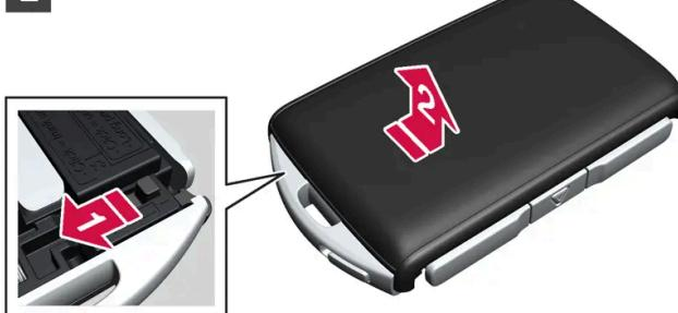
Glissez vers le côté le verrou situé derrière la coque de la partie avant et glissez la coque de la partie arrière dans le sens opposé de l'anneau.
