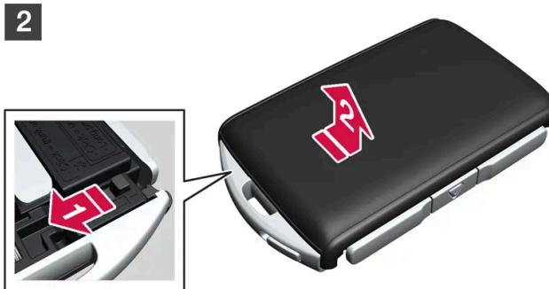
Glissez vers le côté le verrou situé derrière la coque de la partie avant et glissez la coque de la partie arrière dans le sens opposé de l'anneau.
