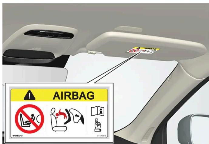
Autocollant sur le pare-soleil du côté passager.
