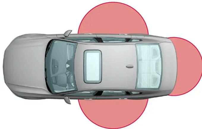
Pour les fonctions sans clé, une clé doit se trouver à une distance de 1 à 1,5 mètre (3 à 5 pieds) environ des portes ou du coffre à bagages de la voiture.
