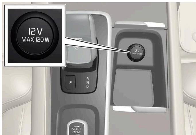
Prise électrique avant de console de tunnel pour voitures sans chargeur sans fil de téléphone\*.
