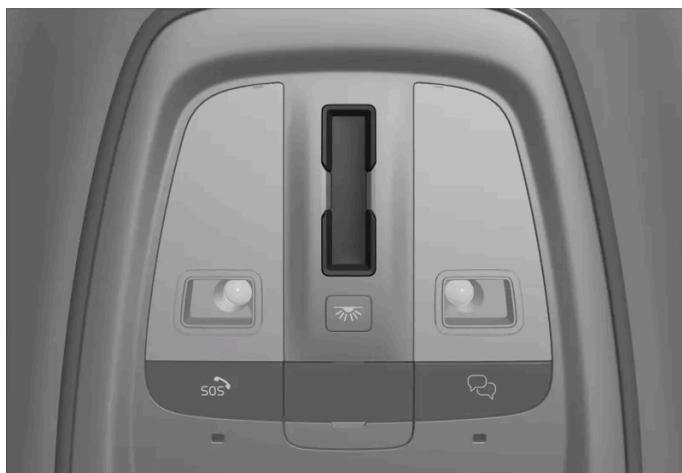
Le toit ouvrant est manœuvré par une commande placée dans le toit. La commande est activée lorsque le système électrique est en position de contact I ou II.
