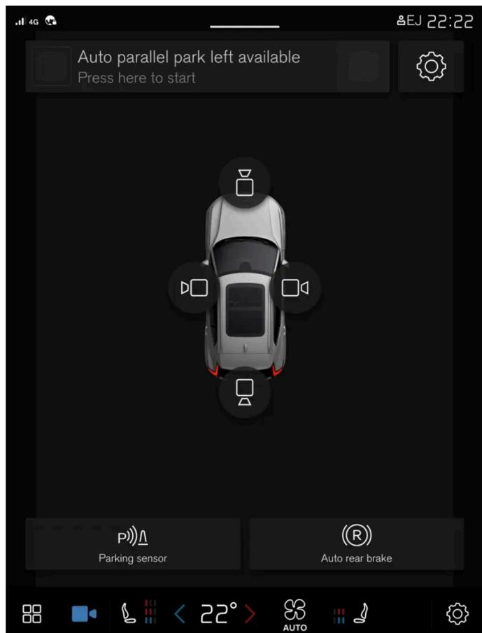
La vue Caméra affiche les images des caméras d'aide au stationnement (PAC<sup>[1]</sup>), qui donnent une vue à 360° ainsi qu'une vue séparée pour les quatre caméras : arrière, avant, gauche ou droite.
