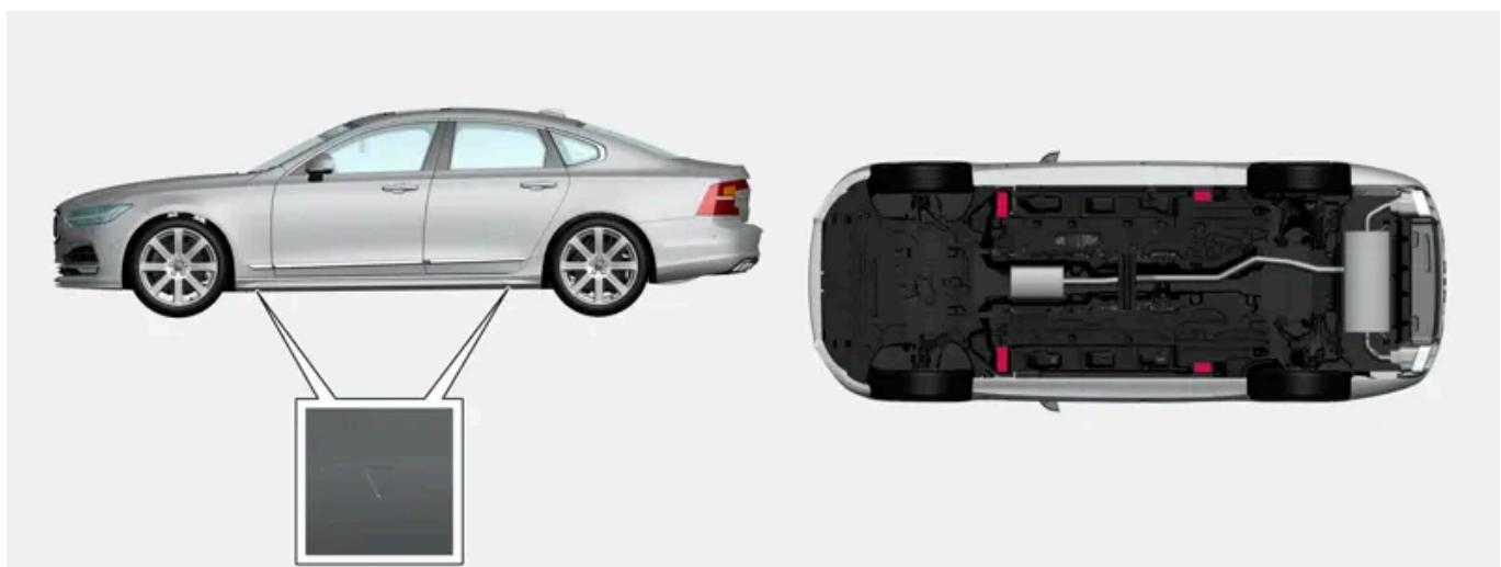
Les triangles du cache en plastique sont orientés vers l'emplacement des fixations du cric/points de levage (en rouge).
