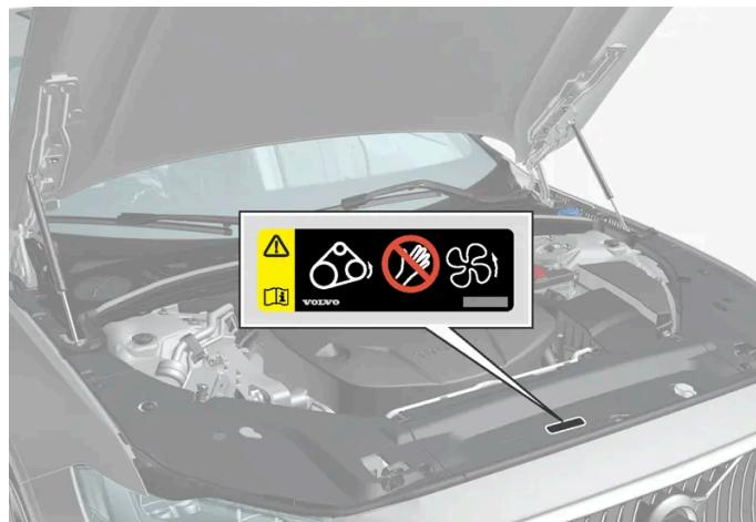
Emplacement de l'autocollant d'avertissement pour le compartiment moteur. L'aspect du compartiment moteur peut être différent suivant le modèle et la version du moteur.
