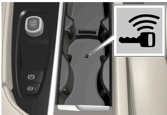
Placez la clé sur le symbole en forme de clé dans le lecteur de secours du porte-gobelet de rangement de la console du tunnel.
