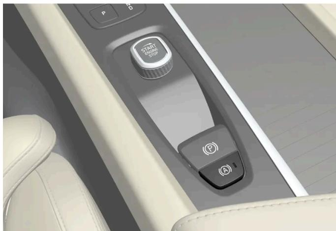
1 Appuyez sur le bouton de la console de tunnel pour activer ou désactiver la fonction.
