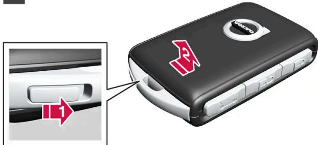
Glissez le verrou à côté de l'anneau d'attache vers le côté et glissez la coque de la partie avant dans le sens opposé de l'anneau.
