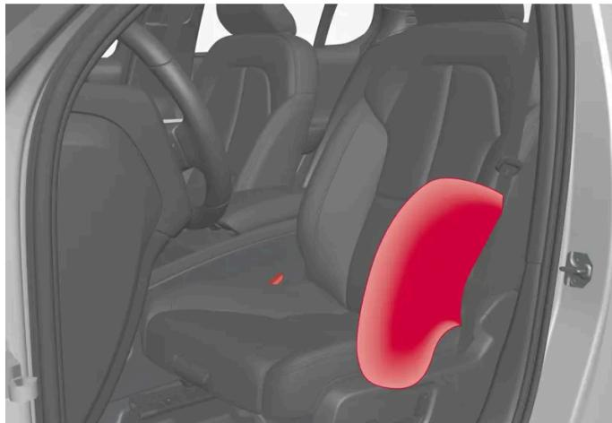
Les coussins gonflables latéraux extérieurs sont montés dans les cadres extérieurs des dossier des sièges avant et aident à protéger le conducteur et le passager des sièges avant.
