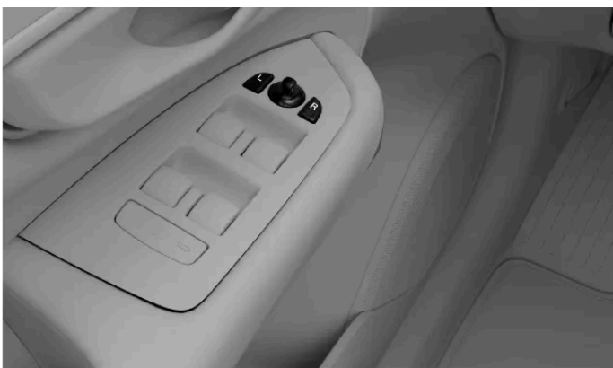
Commandes de réglage des rétroviseurs extérieurs
