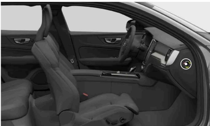
Position de l'interrupteur de coussin gonflable passager
