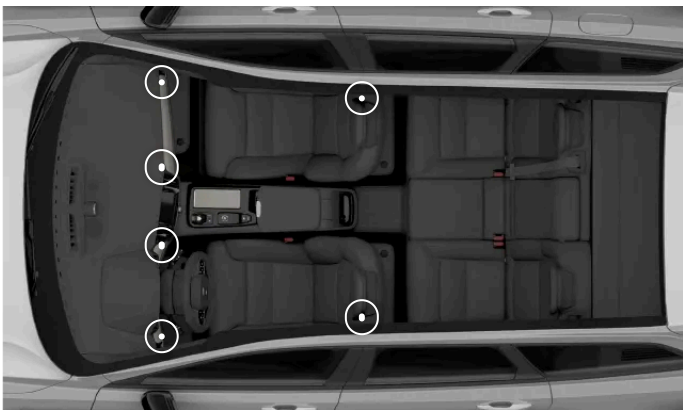
Position des buses de ventilation réglables
