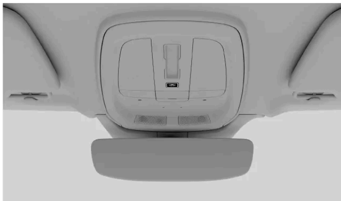
Bouton d'activation de toutes les lampes intérieures sur la console au plafond
