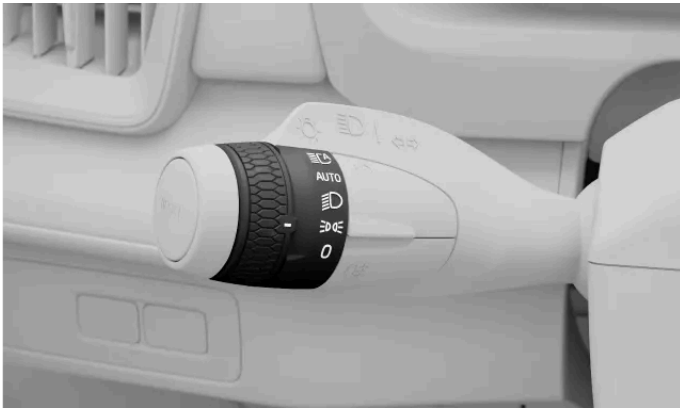
Symbole des feux de position sur la bague tournante du levier de commande gauche
