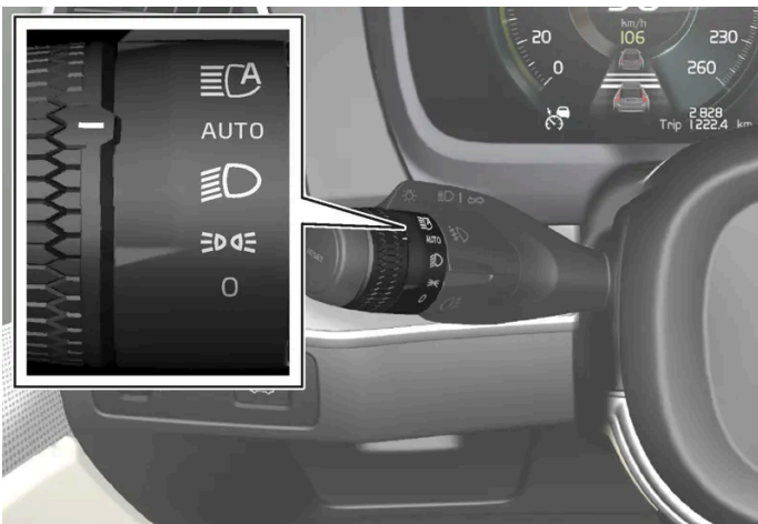
Molette du levier gauche au volant
