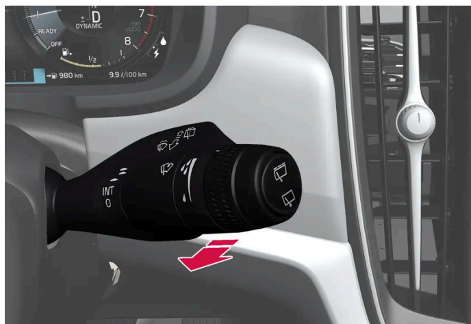
Fonction lave-glace, levier droit au volant
