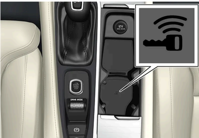
Emplacement du lecteur de secours dans la console tunnel.
