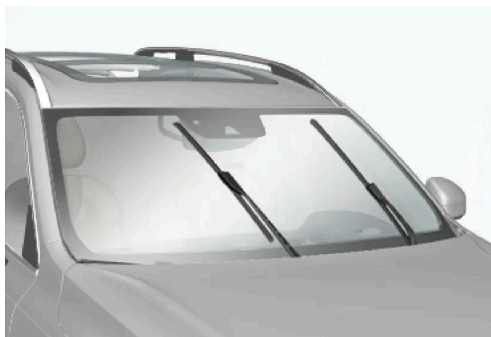
Balais d'essuie-glace en position d'entretien.
