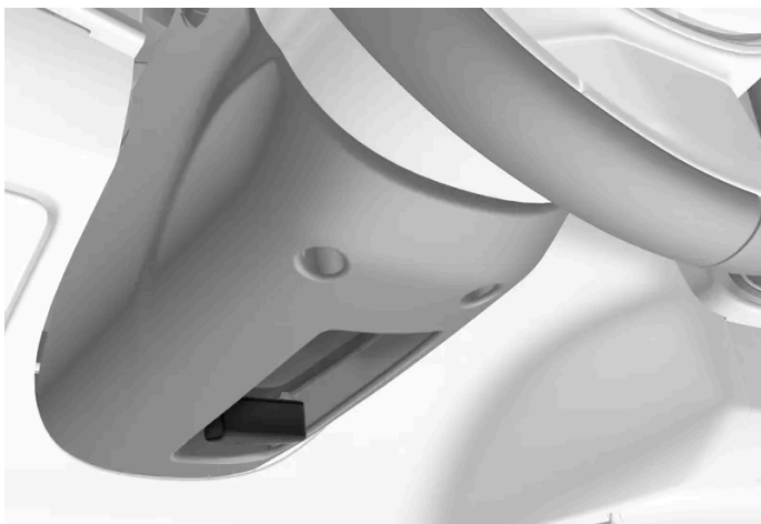
Levier de réglage du volant.
