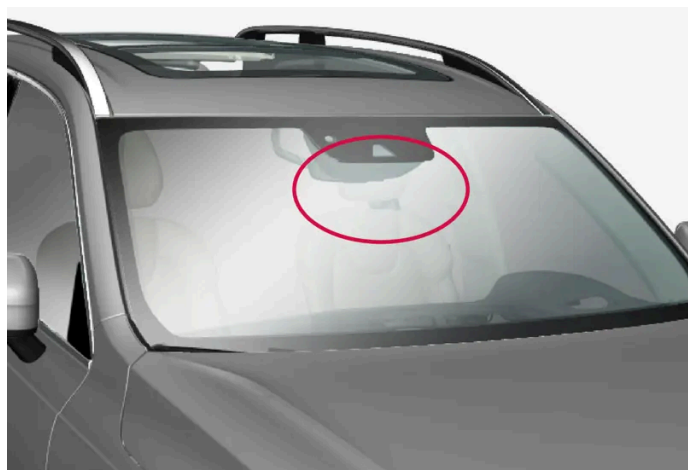
Position de l'unité radar avant
