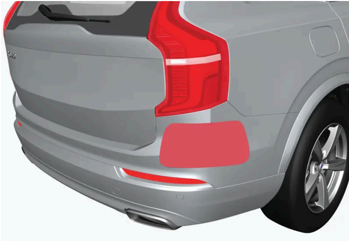
Position des unités radar arrière
