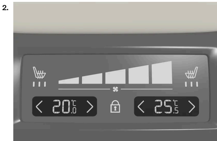
Commande de température sur le panneau de commandes climatiques arrière, sur la console de tunnel.
