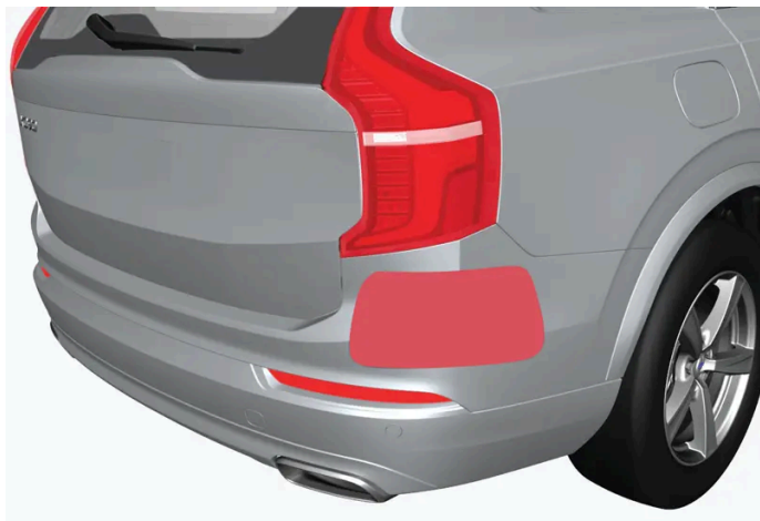
Position des unités radar arrière
