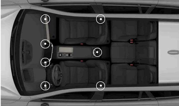
Position des buses de ventilation réglables
