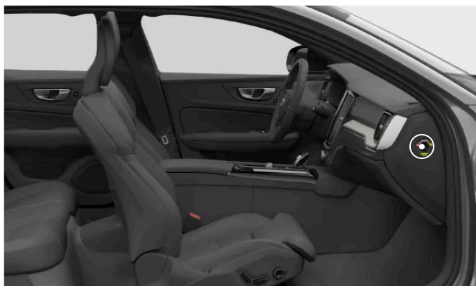
Position de l'interrupteur de coussin gonflable passager
