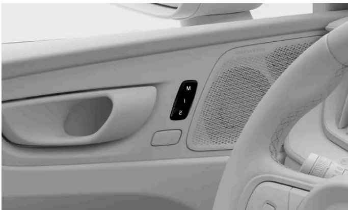
Emplacement des boutons de préréglages de siège
