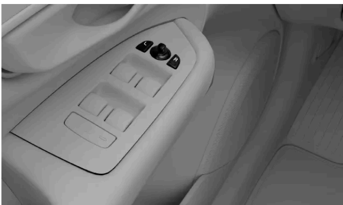
Commandes de réglage des rétroviseurs extérieurs
