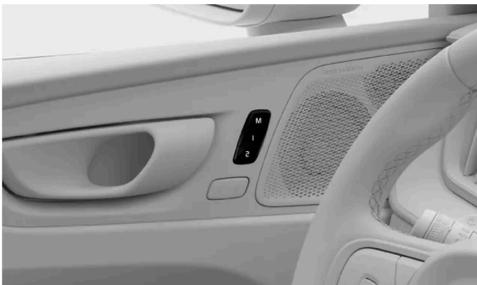
Emplacement des boutons de préréglages de siège
