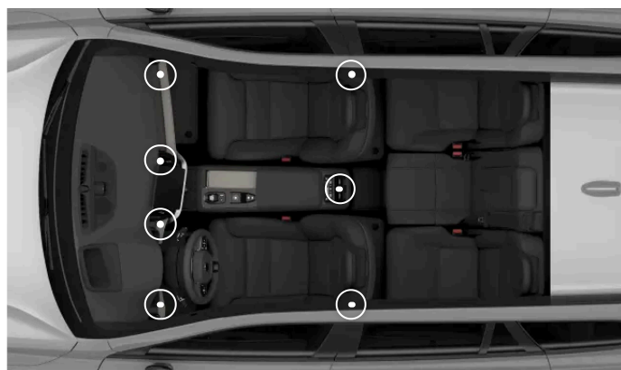
Position des buses de ventilation réglables
