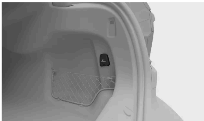
La prise électrique 12 V du côté droit du coffre à bagages
