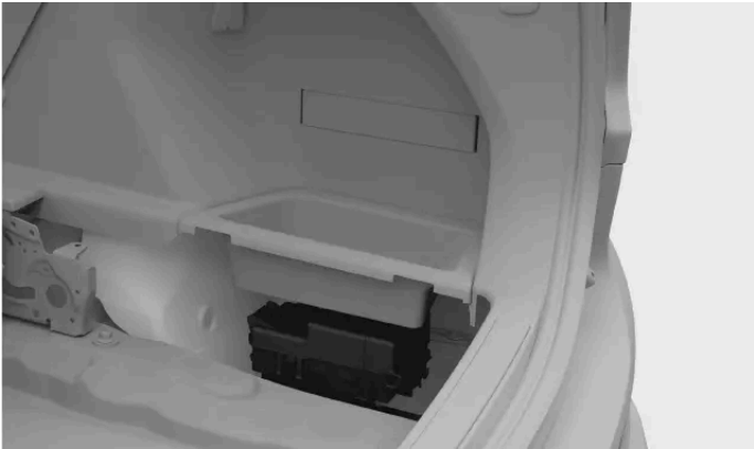
Emplacement de la boîte à fusibles
