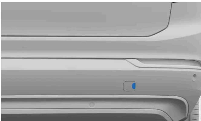
Cache de fixation d'anneau de remorquage arrière
