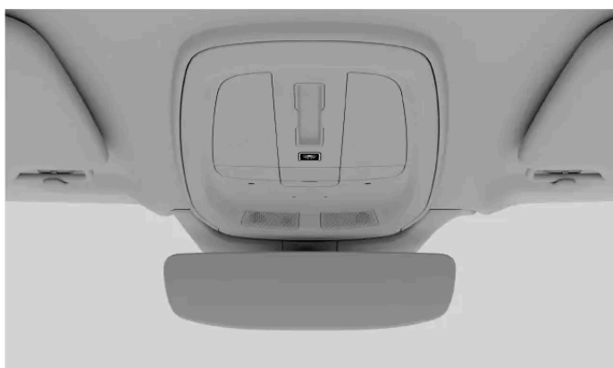
Bouton d'activation de toutes les lampes intérieures sur la console au plafond
