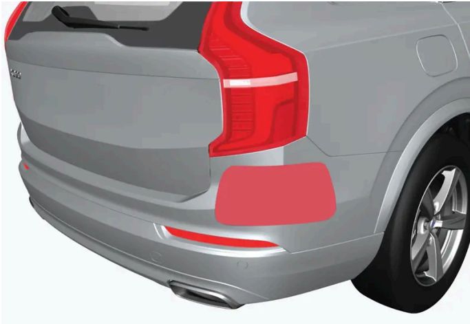
Position des unités radar arrière
