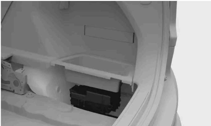
Emplacement de la boîte à fusibles
